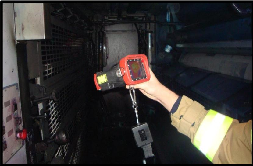
*Bild 4 Temperaturkontrollen mit der Wärmebildkamera*
