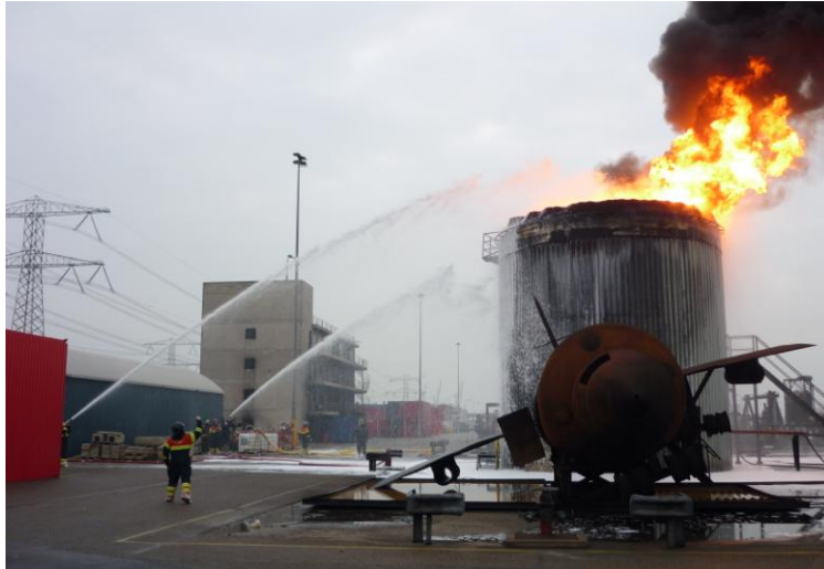
Löschen eines Öltanks mittels je 2 Schwerschäumrohre
