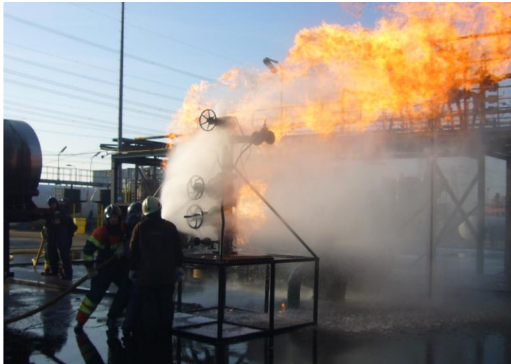
Löschen eines Öltanks mittels je 2 Schwerschäumrohre
